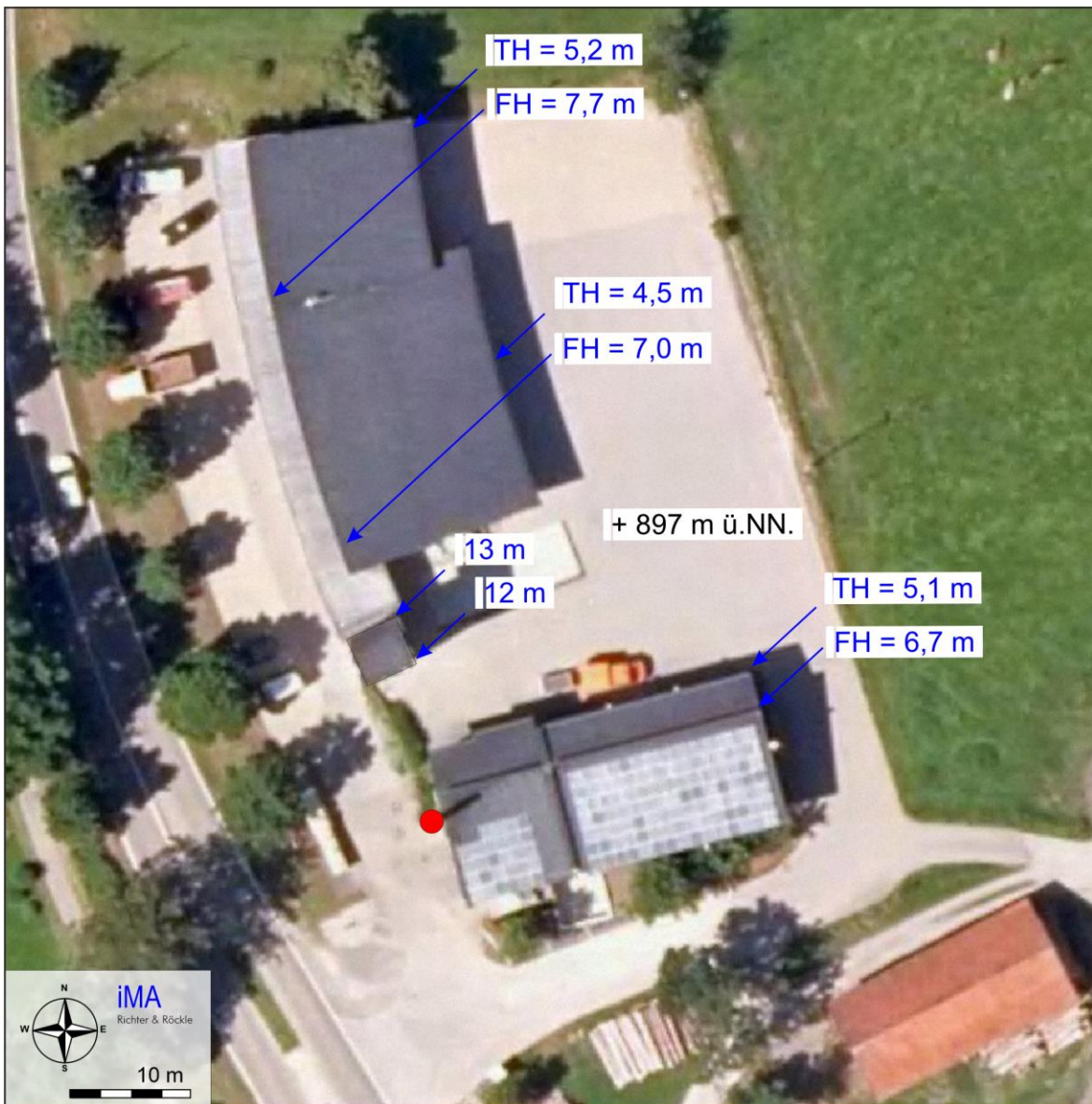
Abbildung 5-2: Gebäudehöhen in der Umgebung Heizwerks, bezogen auf das obere Zugangsniveau des Heizwerks (897 m ü. NHN). Die Zahlen stellen die Trauf- und Firsthöhen in Metern über Grund dar. Der Schornstein ist als roter Kreis dargestellt.
